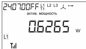
Рис. 12 Меню 10 кадр 2. Мощность активная по фазе А, в Вт
