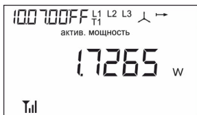
Рис. 11 Меню 10 кадр 1. Мощность активная всего, в Вт
