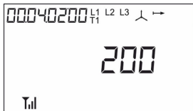
Рис. 20 Меню 12 кадр 11. Начальный кадр подгруппы. Коэффициент трансформации по току. (для счётчиков трансформаторного подключения)
