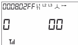
Рис. 19 Меню 12 кадр 2. Разряд 1 - запрет/разрешение перехода на сезонное время: 0 - переход запрещен; 1 - переход разрешен; разряд 2, 3 - автоматическая коррекция времени (диапазон от минус 19 до 19 ppm)
